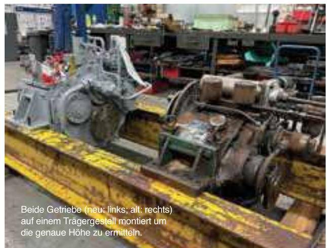
Beide Getriebe (neu: links; alt: rechts) auf einem Trägergestell montiert um die genaue Höhe zu ermitteln.
