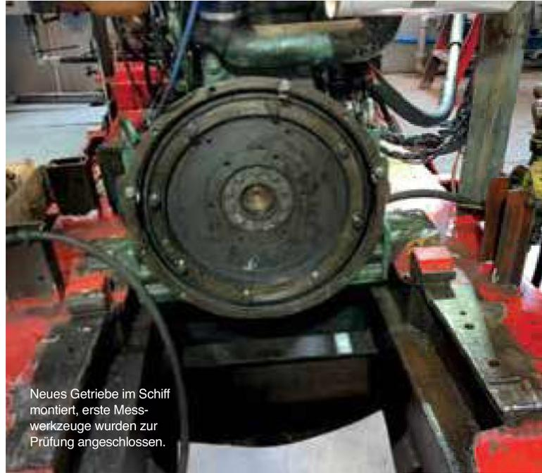
Neues Getriebe im Schiff montiert, erste Messwerkzeuge wurden zur Prüfung angeschlossen.
