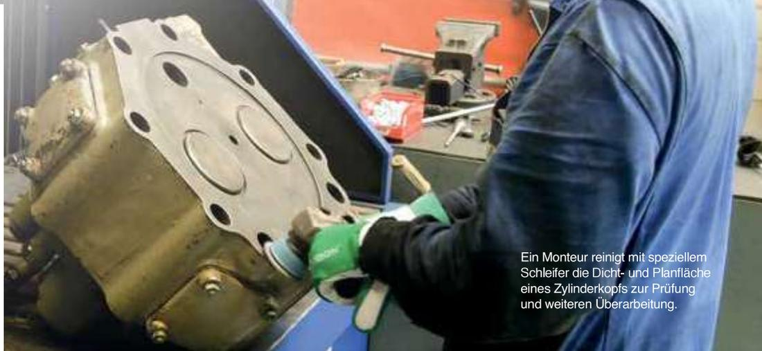
Ein Monteur reinigt mit speziellem Schleifer die Dicht- und Planfläche eines Zylinderkopfs zur Prüfung und weiteren Überarbeitung.
