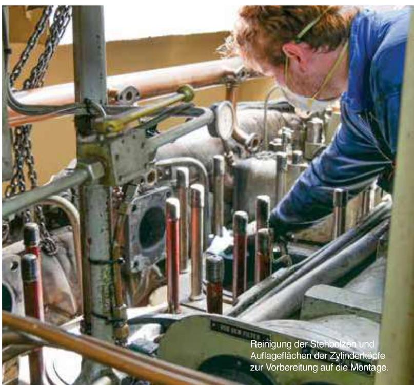
Reinigung der Stehbolzen und Auflageflächen der Zylinderköpfe zur Vorbereitung auf die Montage.
